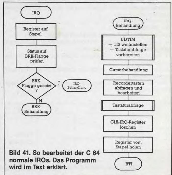
Bild 41. So bearbeitet der C 64 normale IRQs. Das Programm wird im Text erklärt.
